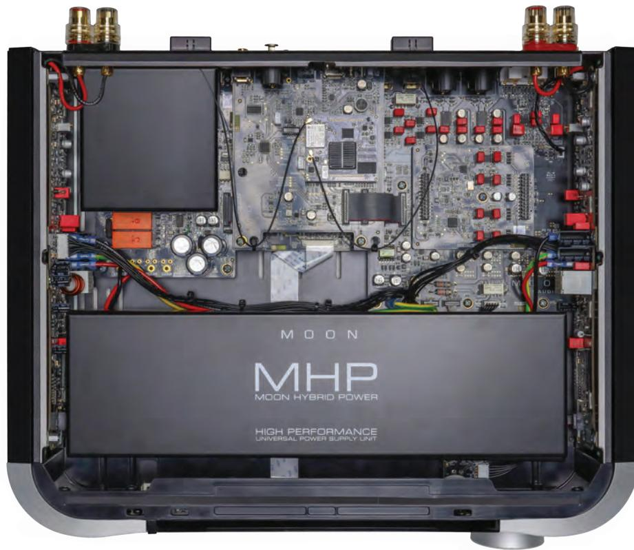
Entièrement conçu et assemblé par Simaudio au Québec, la haute qualité de construction du MOON 371 permet une garantie de 10 ans. L'alimentation hybride MHP est isolée dans un boîtier blindé.
