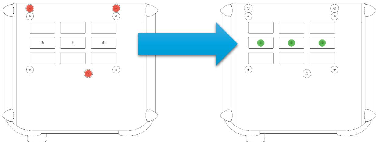
*Remettez toujours les vis de transport à leur emplacement d'origine pour fixer les composants électroniques flottants lors du transport ou de l'expédition de l'appareil.*
